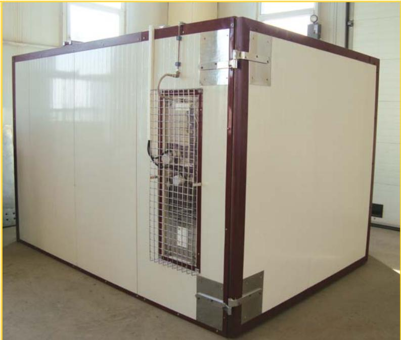
Kuruma süreleri çok uzun olan ahşap üzeri boyalı uygulamalarda infrared ısıtıcılar ile ısıtılan fırınlarda 1-2 saat te kuruma sağlanmaktadır.
